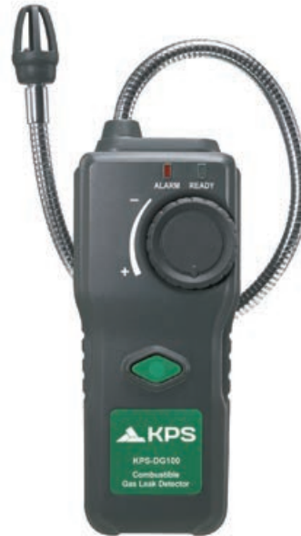
KPS-DG100 Combustible gas detector
